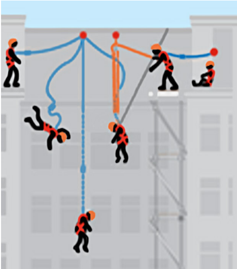
Abb. 29: Improvisierte Rettung mit einer Rettungsausrüstung
