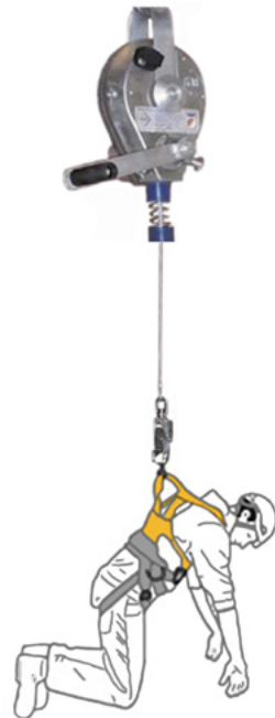
Abb.28: Rettung mit einem Höhensicherungsgerät (BABS)
