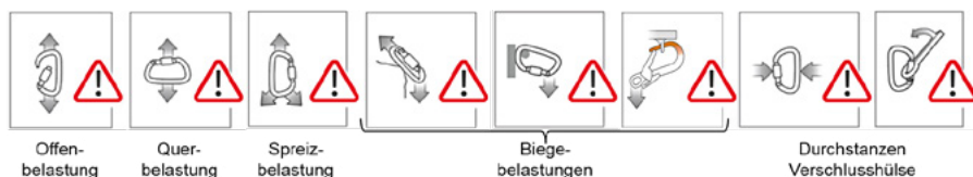
Abb.10: Fehlbelastungen bei Karabinerhaken (Petzi)
