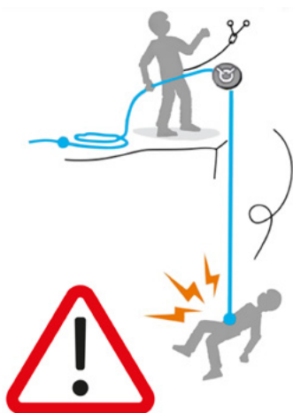
Abb. 15: Fangstoss beim Auffangen eines Sturzes (BABS)
