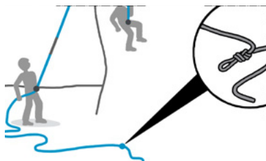
Abb. 36: Jedes Seilende muss gesichert sein (Petzl)
